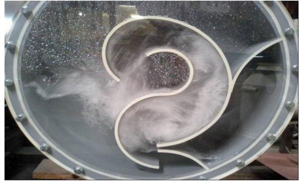
写真-5 VOC処理装置(スクラバー)
