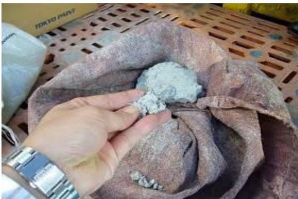
写真-2 ミタゲン処理された塗料スラッジ
